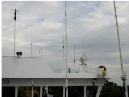
Рис. 12. Утоньшение конструкции антенн, несмотря на их некоторую вибрацию, позволяет без ущерба для эксплуатации значительно сократить материалоемкость, улучшить эксплуатационные качества
