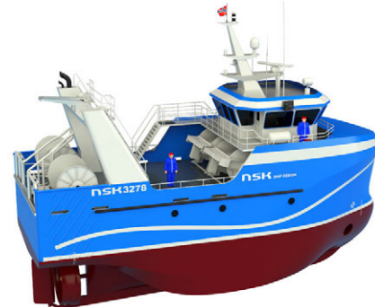
Рис. 20. Путем разделения надводного борта судна различными продольными тонально-цветовыми элементами удается скорректировать очевидные диспропорции корпуса, визуально гармонизовать экстерьер
