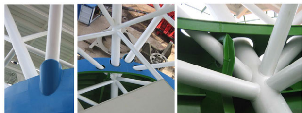
Рис. 15. Разделение нагрузки на составляющие: а) вид на фальшборт снаружи судна (виден обтекатель, как продолжение фальшборта, конструктивно со стойкой не связанный); б) вид сверху на горизонтальную поверхность (планширь) фальшборта с проходящими через отверстия стойками площадки (хорошо видны зазоры между конструкциями); в) «пучек» опор, проходящих через фальшборт
