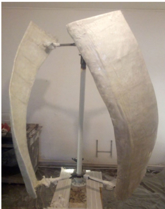
Рис. 5. Криволинейные лопасти с нанесенным армирующим слоем
